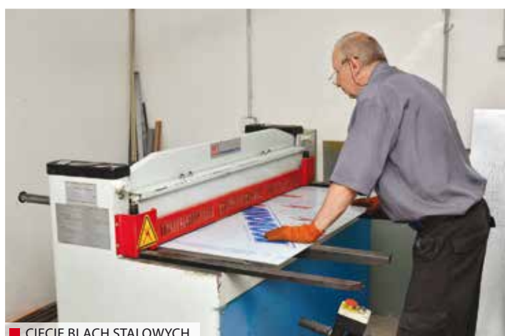
■ CIĘCIE BLACH STALOWYCH
